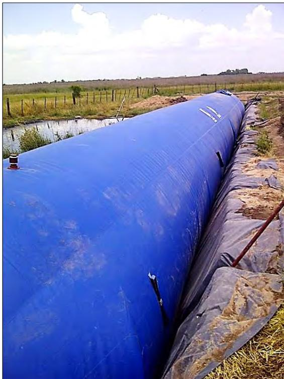
**Kit MAX B500:** Este equipo es para 350 a 500 madres viene provisto con salida para un solo digestor ya que si lo fabricáramos como el modulo anterior la caja de carga y descarga encarecería mucho el costo del producto. Si quisiéramos incorporar mas madres tendríamos que anexar otro kit de acorde a la necesidad.
