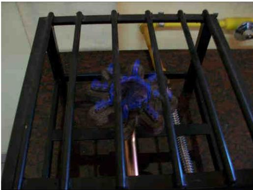
Figura 40 – Quemador de biogás en funcionamiento.
