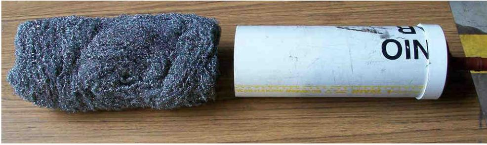
**Figura 22** – Relleno del caño con virulana de acero.
