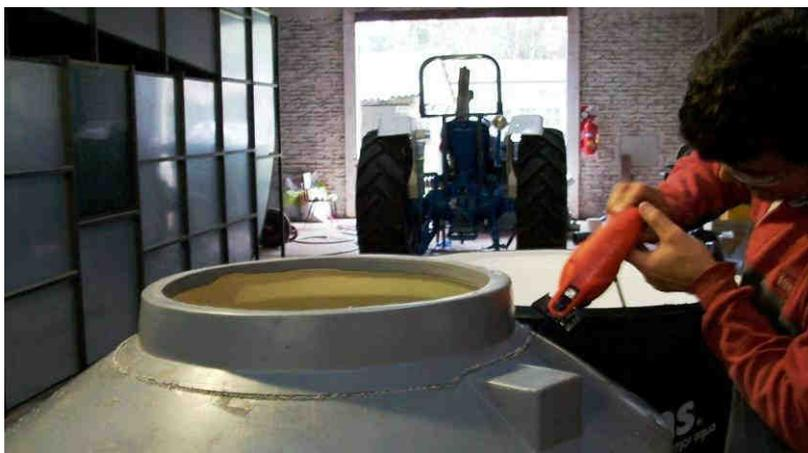
**Figura 18** – Corte del tanque de menor diámetro por debajo de la boca del mismo.
