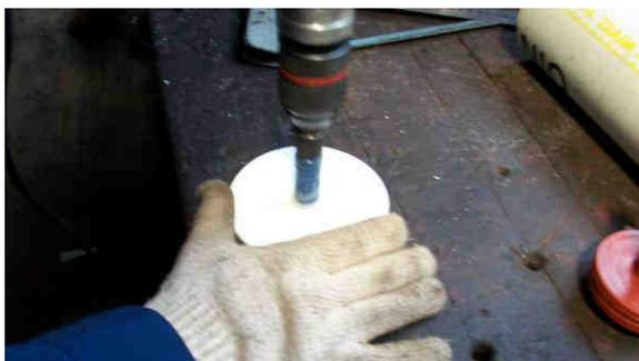
Figura 20 – Perforación de tapa para trampa de sulfhídrico.
