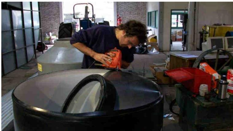
**Figura 17** – Corte de tanque de mayor diámetro, encima del comienzo del cono.
