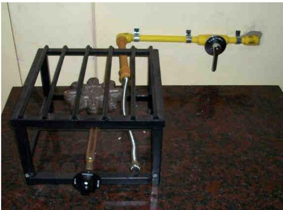
**Figura 39** – Quemador de biogás.
