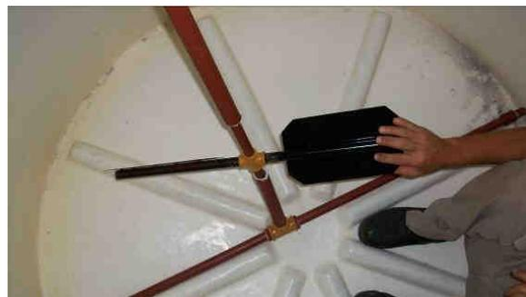
**Figura 13** – Montaje de agitador dentro del biodigestor.
