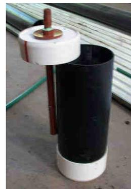
**Figura 24** – Vista de caño PVC, salida de tanque y caño de PP de 25 cm.
