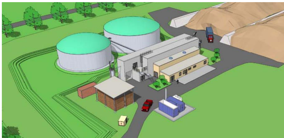
Ilustración de una planta de biogás de principio flujo pistón
