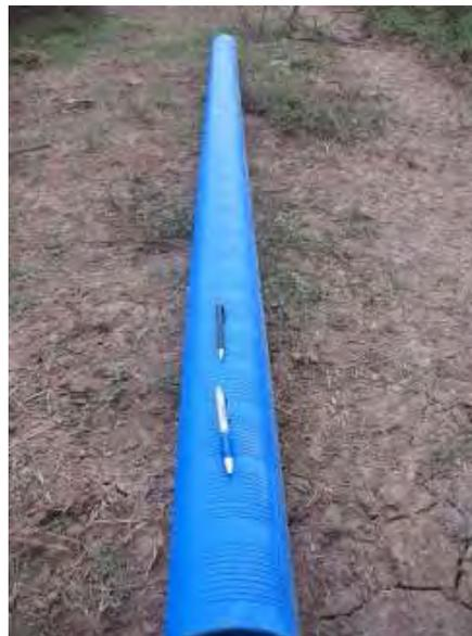
**Filtro artesanal con ranuras horizontales de 0,75 mm de espesor y 4,70 m de largo.**
