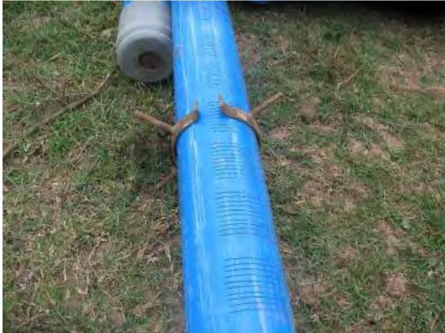
**Detalle de una de las guías del filtro para quedar bien centrado dentro del encamisado de manera que el paquete del prefiltro sea uniforme en todo el perímetro de la perforación.**
