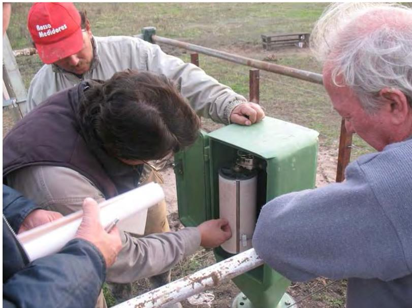
**Calibrando el freatógrafo a fajas para evaluar el nivel del agua en el acuífero sin la interferencia de bombeo**
