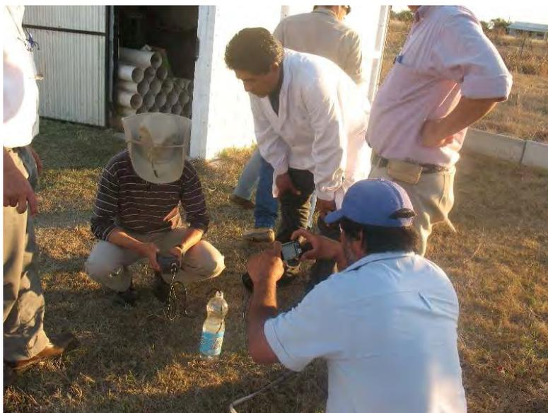
**Midiendo la conductividad eléctrica de la perforación que alimenta la planta de ósmosis inversa a diferentes profundidades**
