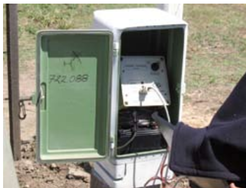
Limnógrafo digital de alta precisión instalado en el Campo "La Güeya".
