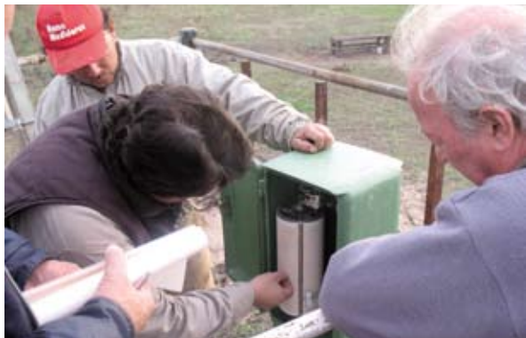
Calibrando el freatígrafo a fajas para evaluar el nivel del agua en el acuífero sin la interferencia de bombeo.
