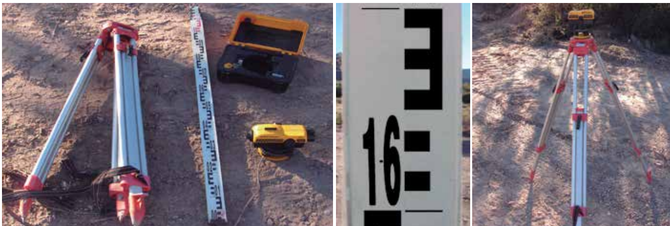
Nivel óptico, mira graduada y trípode.
