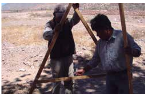
Pasos para la construcción del Nivel "A".
