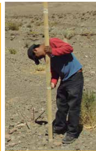
Medición de desniveles con Nivel de Manguera.
