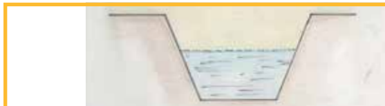
Canal de sección trapezoidal.
