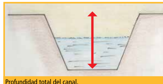
Profundidad total del canal.
