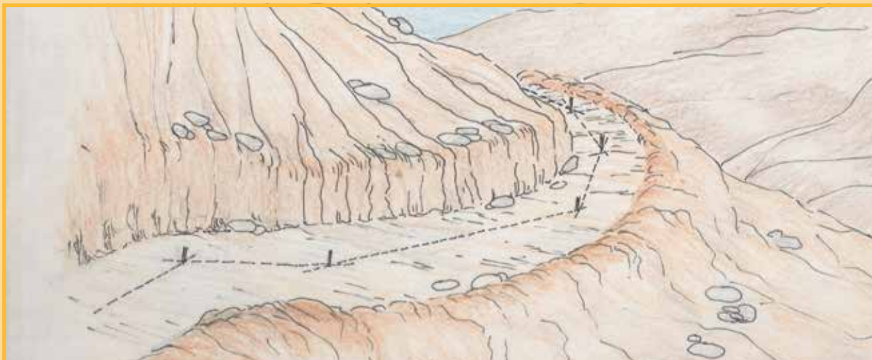
Marcación del eje del canal.
