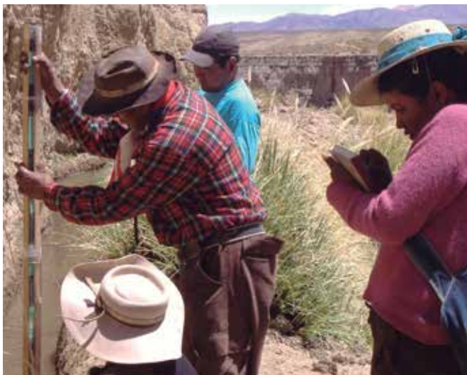
Medición de desniveles mediante nivel de manguera. Comunidad Carrizal, Jujuy.
