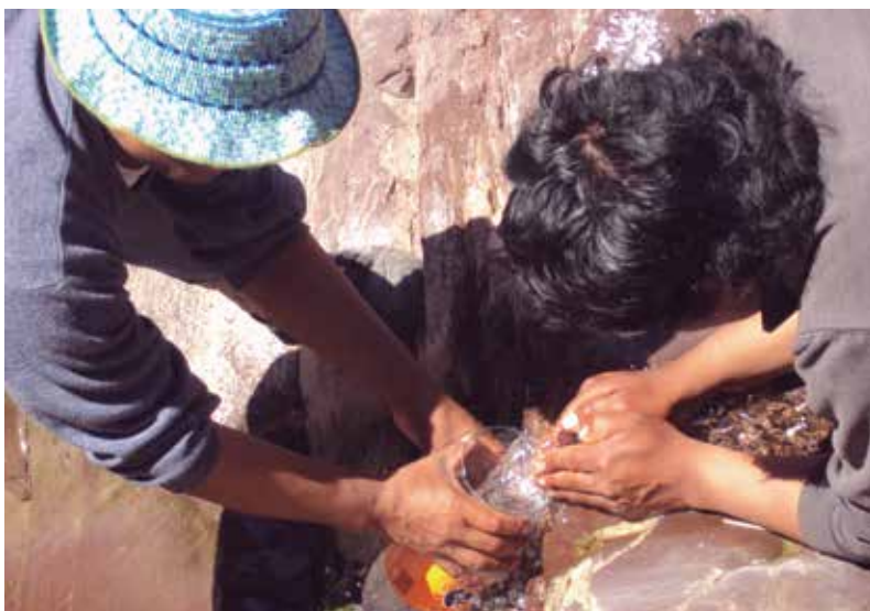
Mediciones de caudal mediante método volumétrico.
