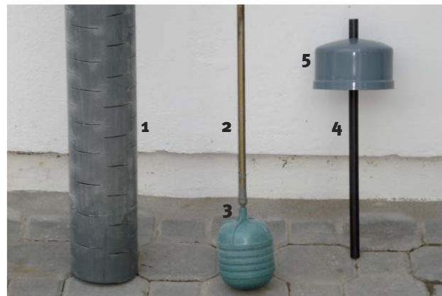
Figura 1. Componentes del freatímetro de lectura directa: (1) Caño ranurado de 110 mm (2 m), (2) Varilla metálica de 12 mm de 2 m, (3) Flotador, (4) tubo de PVC de 16 mm, (5) tapa de PVC 110 mm
