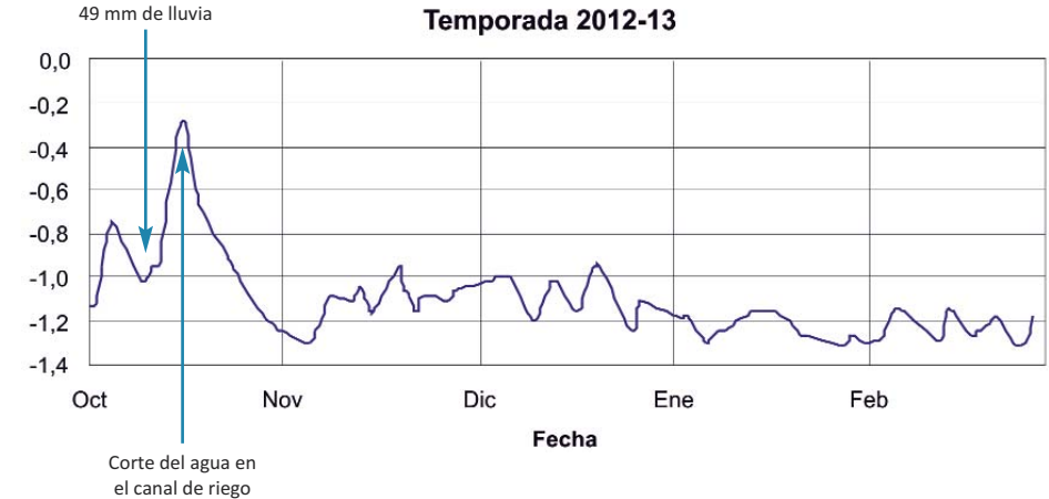
Figura 7. Ubicación de la capa freática en un monte de peral durante la temporada 2012-2013. Estación Experimental INTA Alto Valle
