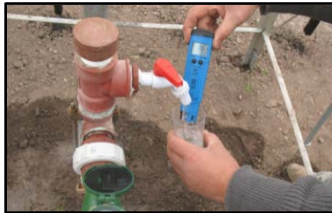
Figura 6- Medición de la conductividad eléctrica del agua bombeada en cada sistema analizado.
