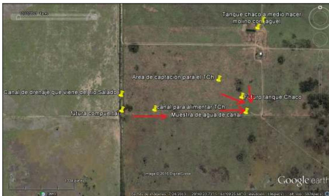
**Imagen satelital del tercer tanque de tierra propuesto, que se alimentará de un área sistematizada para captar agua de lluvia y también del canal que se abastece del río Salado. Se propuso implementar una compuerta en dicho canal que permita su ingreso solo si la calidad es aceptable.**
