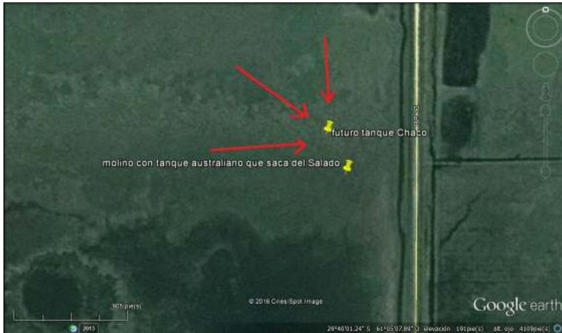
**Imagen satelital con la ubicación del primer tanque de tierra a implementarse en la nueva entrada al Establecimiento, donde se puede apreciar el sentido de la pendiente del terreno respecto al lugar elegido para concretar el área de captación de dicho reservorio.**
