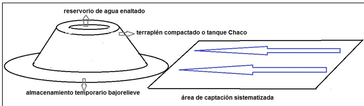
El almacenamiento temporario bajo relieve debe tener capacidad de almacenar el agua de una lluvia de diseño, la cual provenga del área de captación sistematizada, pero a su vez hay que tener cuidado de no tener contacto con la napa altamente salinizada.
