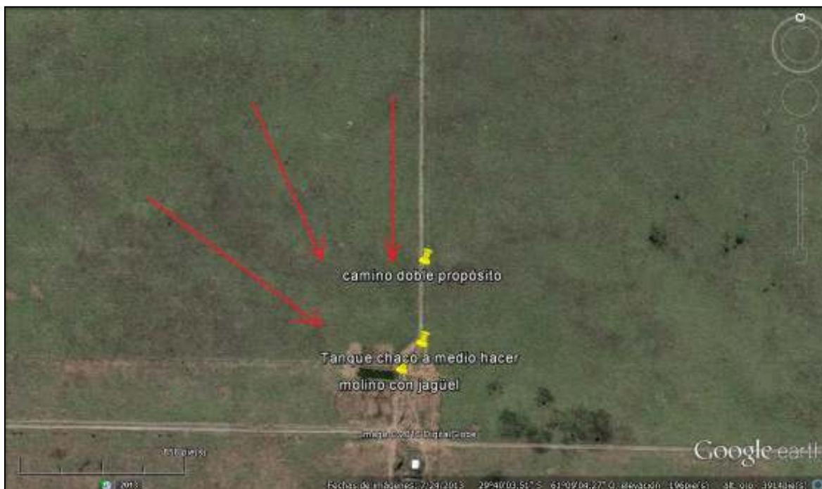
**Imagen satelital del sistema que está funcionando en la actualidad con jagüel alimentado con agua de lluvia y en el que están construyendo un tanque de tierra con un jagüel interior en forma de T, con un camino que puede servir para incrementar el área de captación, así como también las líneas rojas marcan la pendiente del terreno natural.**
