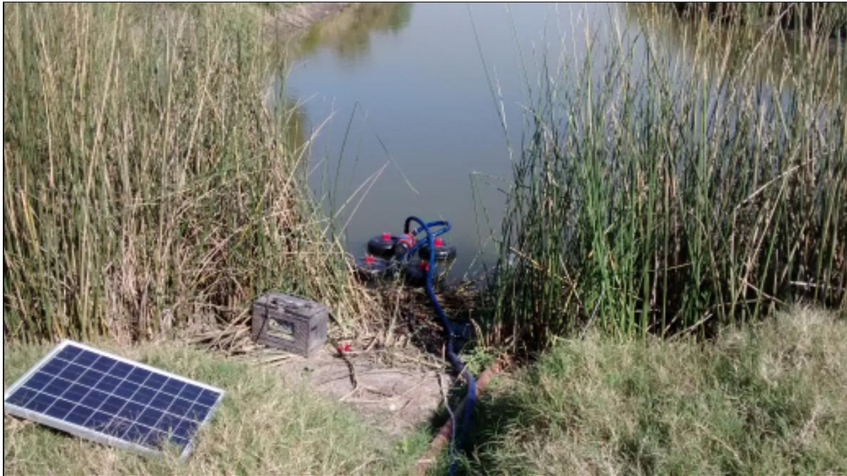
**Sistema de abastecimiento compuesto de bomba centrífuga alimentada con energía solar con chupador flotante, ideal para manejar sustentablemente este tipo de aguadas, ya que el agua se debe extraer de superficie y lentamente (caudales bajos) acorde a la capacidad del acuífero.**
