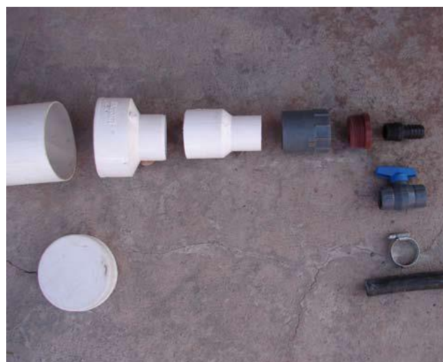
Fotos 5 Vista de los materiales empleados para la captación
