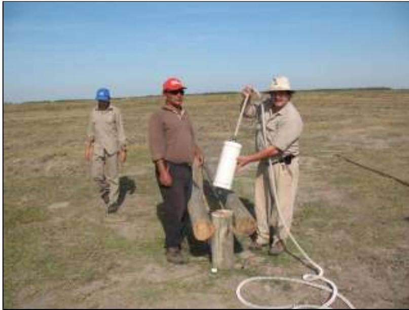
**Fig. 9-** Diseño de chupadores flotantes en perforaciones para los mecanismos de bombeo. Diseño: Lahitte, A.
