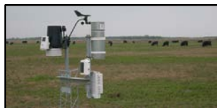
Figura4- Estación meteorológica automática y pluviómetro Tipo B instalados en “La Güeya”.
