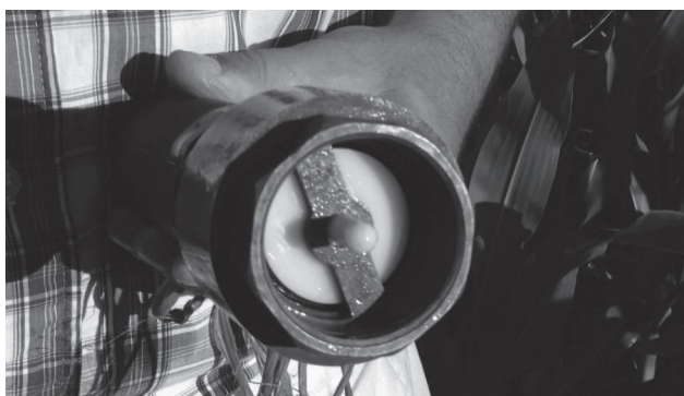
Foto 4. Dispositivo construido con válvula de paso de plomería.
