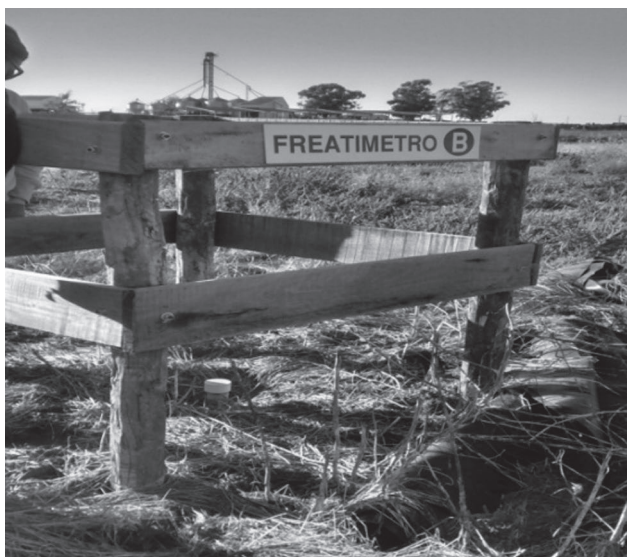
Foto 3. Ejemplo de clausura e identificación de freatímetro mediante "corral de madera".
