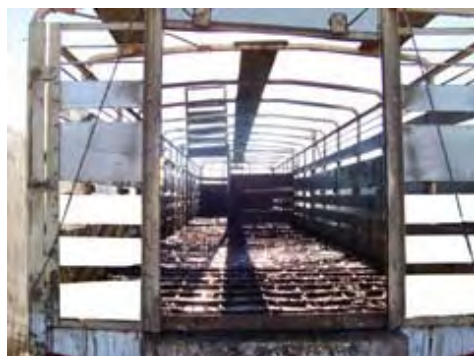
Figura 21: Vehículo de transporte de hacienda sin rodillos.
