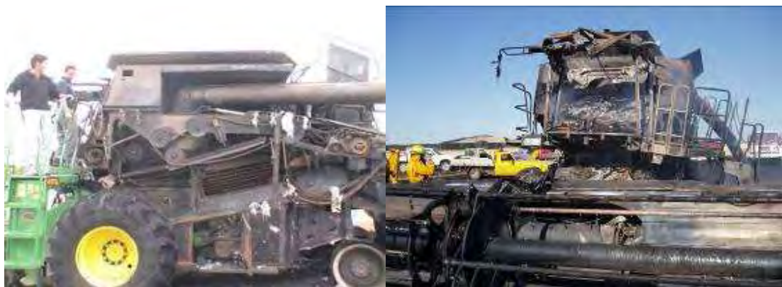
FIGURA 1: máquinas que sufrieron destrucción total por incendio en plena cosecha.
