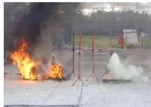
Figura 11: Etapa de extinción, donde se observa el comienzo del trabajo del agente extintor ABC 90 expelido por las toberas de prueba sobre las bandejas de evaluación.
