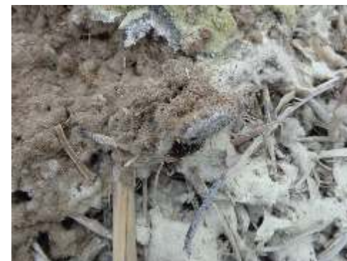
Figura 13: En las bandejas de evaluación, luego de la etapa de extinción, se evidenció que el agente extintor ABC 90, encapsula a los focos de fuego, privándolos de Oxígeno y minimizando los riesgos de reignición.
