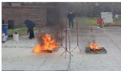
Figura 10: Superior: operario listo para encender las bandejas de evaluación “A” y “B”. Inferior: periodo de combustión de 20 segundos buscando lograr una temperatura importante.
