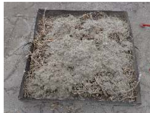
Figura 6: Bandeja de evaluación preparada con combustible tipo "A": residuo de cosecha de soja y sorgo.
