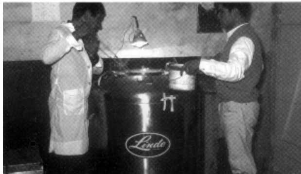
Termo conservador del semen congelado de una capacidad de 200 litros de nitrógeno líquido perteneciente al King Ranch Argentina y en donde además se procedía (por su boca ancha) a la congelación por medio de los vapores del N 2 L.
