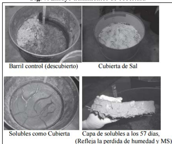
Fig. 7. Ensayo tratamientos de cobertura
