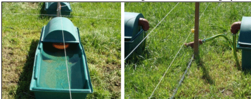
Fotos 20 y 21. Bebederos móviles, línea de agua y conexiones de acople rápido para bebederos móviles (Unidad demostrativa “feedlot Ecológico” INTA C. del Uruguay).
