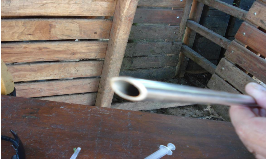
FOTO 1. TUBO “E” MOSTRANDO SU EXTREMO BISELADO Y AFILADO
