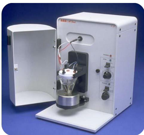
Figura 4: Plataforma BAS C-3 conteniendo la celda para las experiencias voltamperométricas. Electrodo de trabajo: carbono vítreo (negro), electrodo de referencia: AglAgCl|3M NaCl (blanco) y como contraelectrodo: platino (rojo) (Bertolino, 2011).
