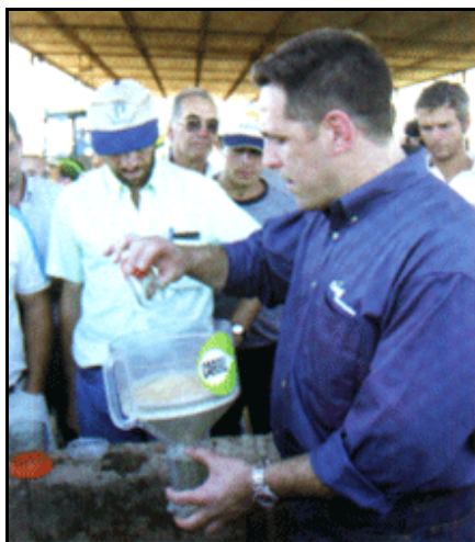
a)-Con el medidor de partícula de Cargill se puede medir el tamaño de molienda de los granos, de los silos de gramíneas y también de leguminosas; b)-Separador de partículas de Pennsylvania que permite visualizar cual es la relación existente en el tamaño de partícula con todos los forrajes de la dieta.
