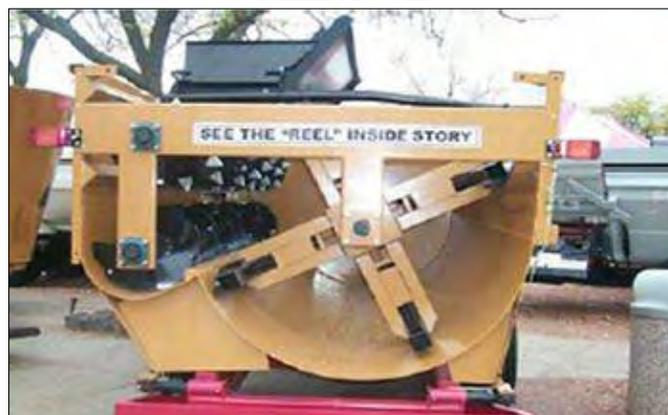
Los rotores (reel augie) fueron los revolucionarios de la mezcla, ya que este sistema logro lo que se busco por muchísimo tiempo: mezcla superior sin sobremezcla y baja potencia necesaria para trabajo.
