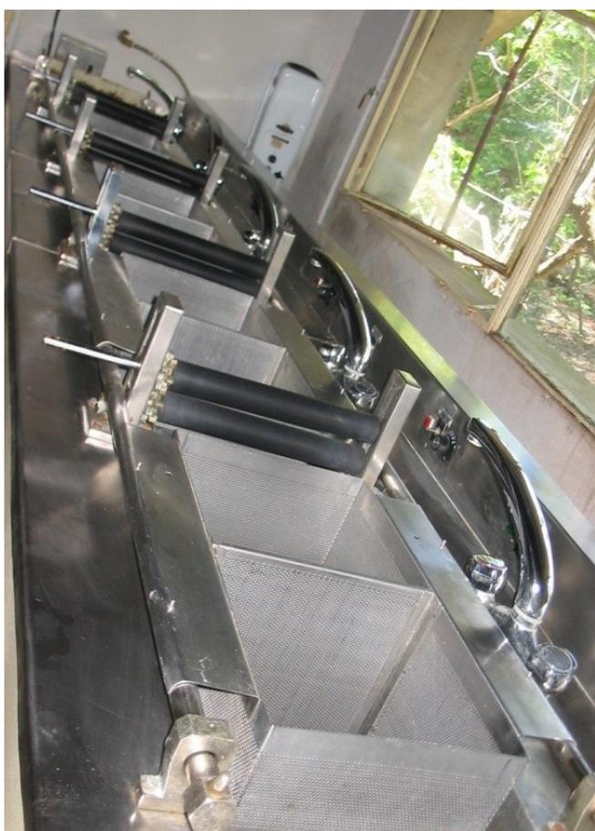
Fig. 6.4 Tren de lavado de fibra en laboratorio
