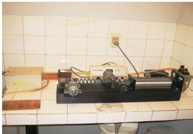
**Fig. 6.12** Staple Breaker para medir resistencia de mecha
