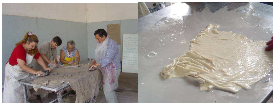
Figura 5 – Proceso de depilado con espátula y piel lista para el desencalado
