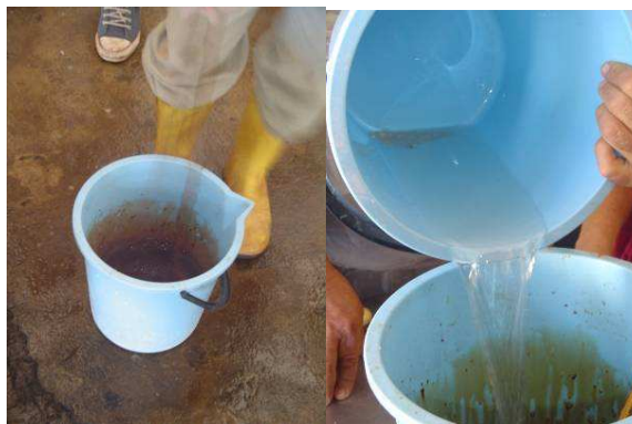
Figura 9 – Preparación del tanino y posterior mezcla con la solución de alumbre
