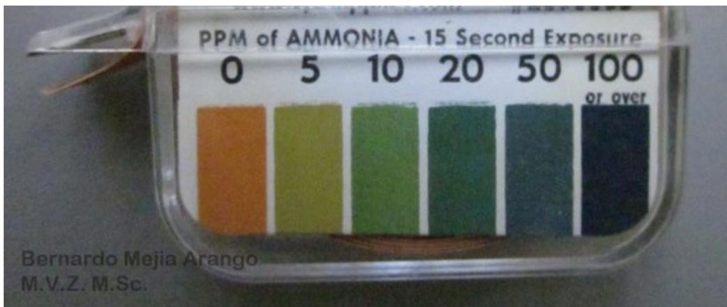
Imagen N° 8. Existen varias metodologías para detectar los niveles de amoníaco en las granjas, desde los más sofisticados que implican el uso de equipos electrónicos, hasta tiras reactivas como la que se muestra en la fotografía, muy fáciles de llevar y de usar.
