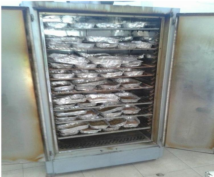
**Figura 2.** Determinación del contenido de materia seca mediante estufa a 105°C
