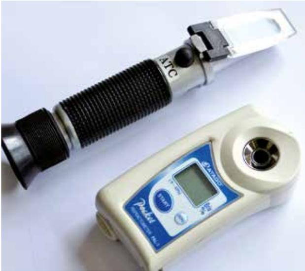
**Figura 2** - Refractómetro óptico (arriba) y digital (abajo).
