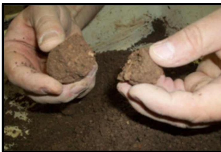
Figura 7. Suelo con contenido de humedad cercano al óptimo: el terrón partido no debe desmenuzarse (muestra de laboratorio).
