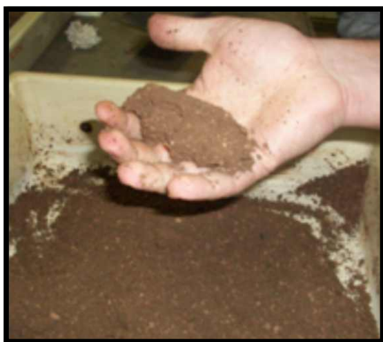
Figura 6. Suelo con contenido de humedad cercano al óptimo para compactar (muestra de laboratorio).
