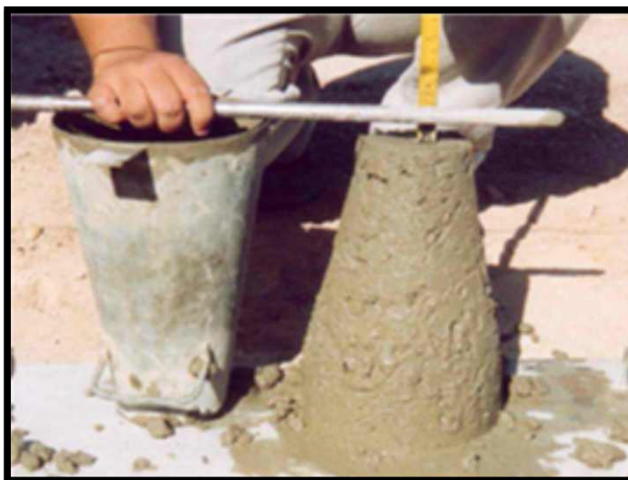
Figura 13. Control del asentamiento con el cono de Abrams. (Fuente: ICPA, 2013).
