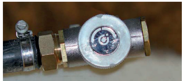
Figura 6. Detector de temperatura asociado a la válvula termostática (GIE Lait-Viande de Bretagne Institut de l'Élevage, 2010).
