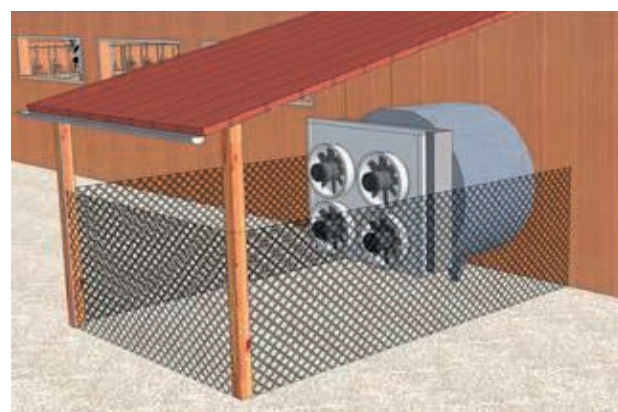
Figura 12. Sala de leche y máquina dividida por un tabique. Ubicación de grupo frigorífico en sala de máquina o en el exterior (foto derecha).
