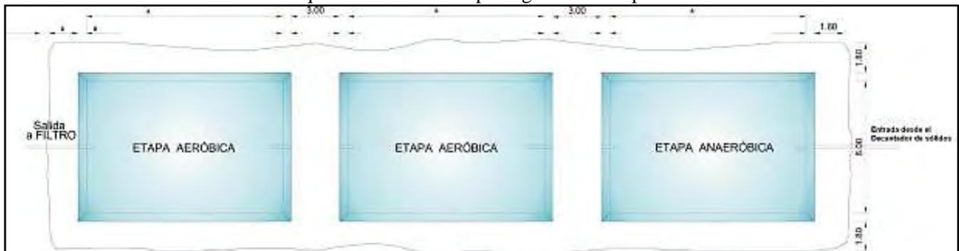
Esquema sistema de triple laguna detalle conexión
