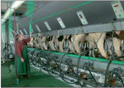
Figura 4. Sala paralelo con medidor electrónico y canal de recogida de deyecciones (izda.) y disposición frontal de la vacas (dcha.).
