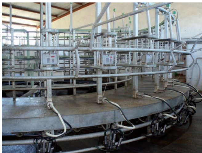
Figura 4. Unidad de ordeño compuesta por: cuatro conjuntos de pezoneras (pezonera, casquillo, tubo corto de leche y tubo corto de pulsación), colector y tubos largos de leche y de vacío.
