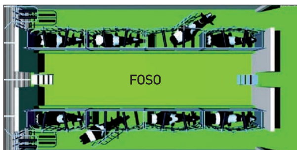
Figura 1: Sala tandem 4x2; distribución de boxes, foso y pasillo de salida.
