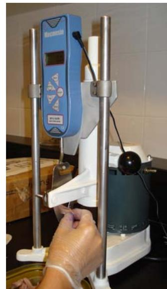
**Figura 7.** Medición de textura con célula de Warner Bratzler.
