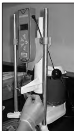
Equipo de cizalla mecánica para medir fuerza de corte de la carne. (Fig.5)
