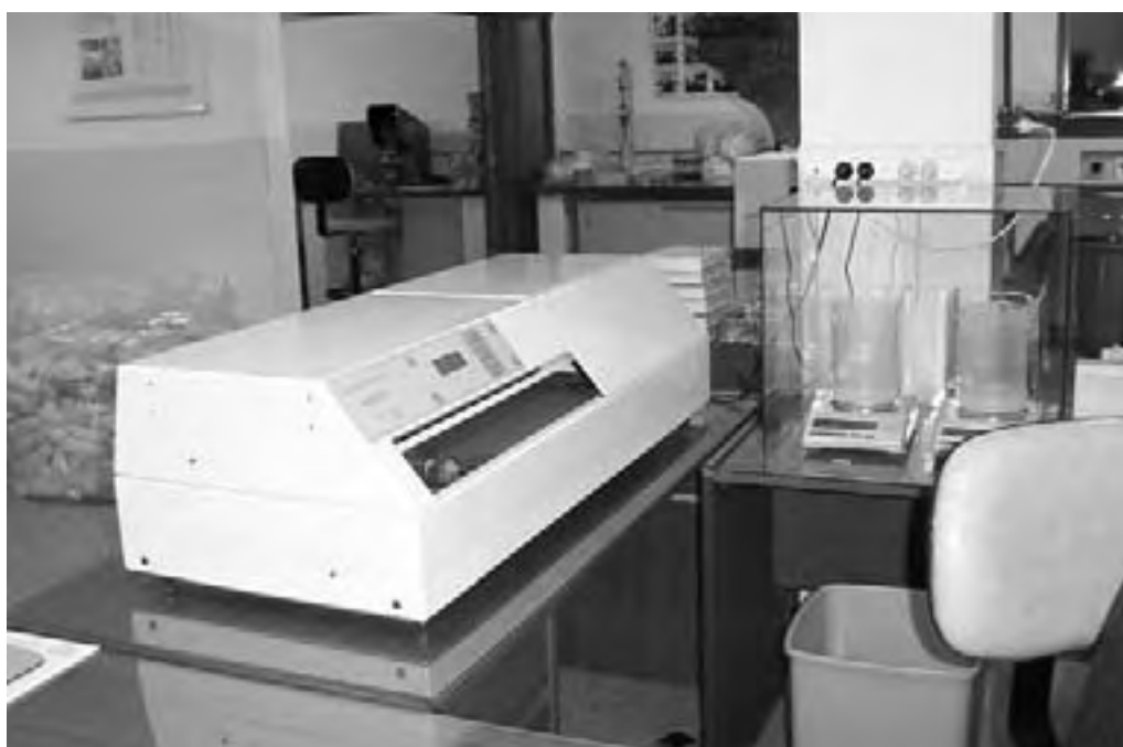
● Equipo Staple Breaker Mod 2 que se utiliza para la medición de Largo de Mecha y Resistencia a la Tracción.
