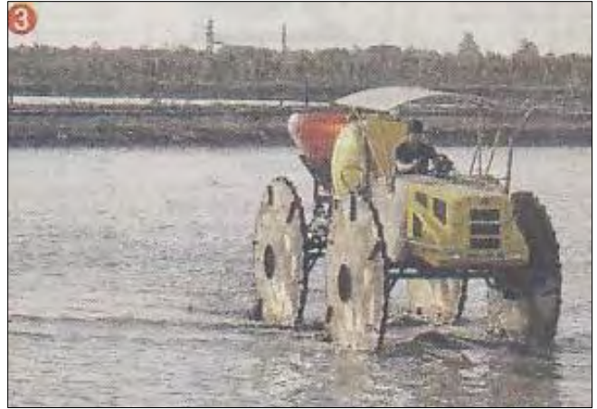
a) Compuertas para la entrada de agua. b) Sembradora brasileña en la siembra del arroz pregerminado sobre lámina de agua.
