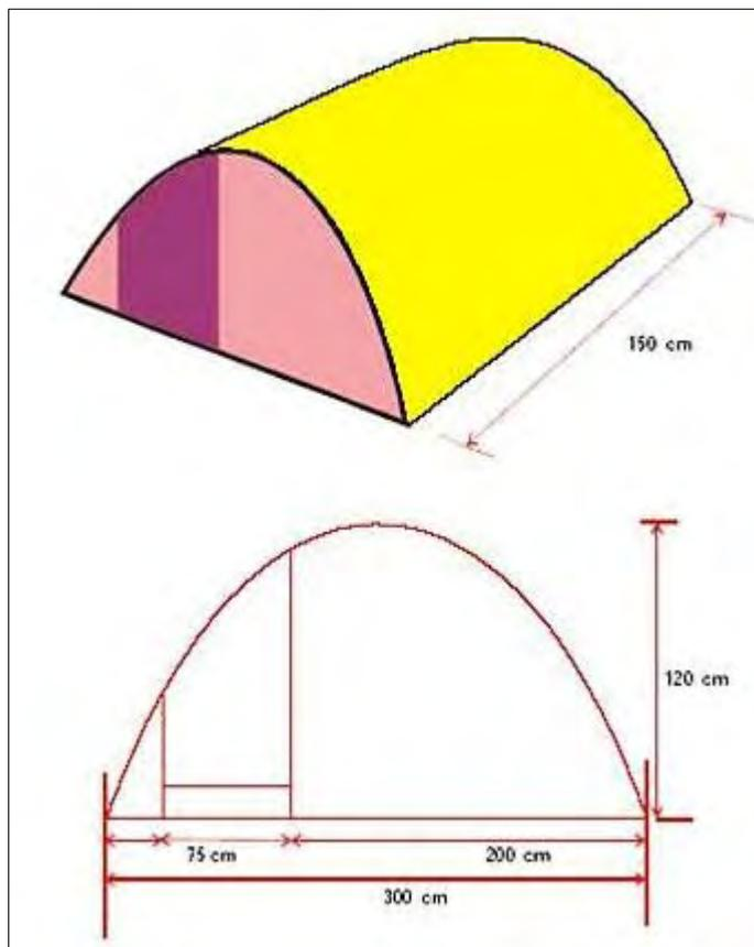
Una vez elegido su lugar definitivo y a fin de asegurar la estabilidad de la paridera e impedir que sea desplazada por el viento, se deberá fijar al suelo mediante estacas sujetas a su estructura. La paridera deberá ubicarse en lugares altos evitar que se inunde con la lluvia.
