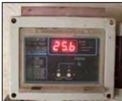
Figura 1.- Control de temperatura.
