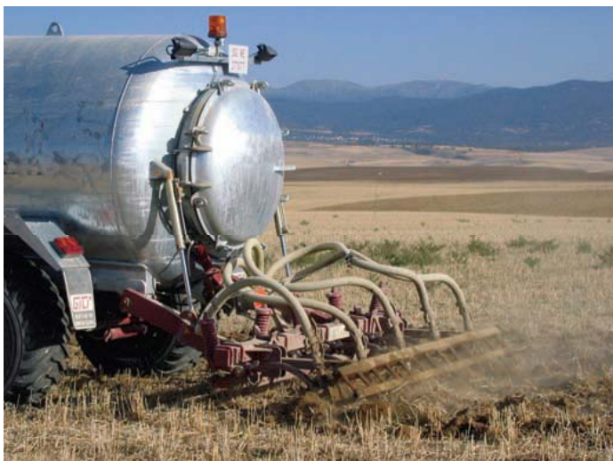
Figura 6. Inyección de purín en el terreno
