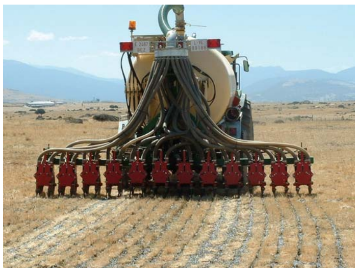
Figura 5. Sistema de aplicación de purín mediante discos
