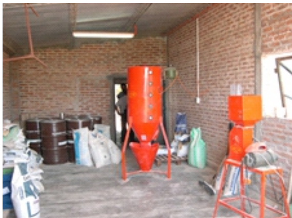
Moledora y mezcladora monofásico - Sáenz Peña - Chaco.
