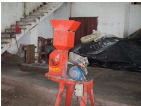
Moledora con motor monofásico - Salta.
