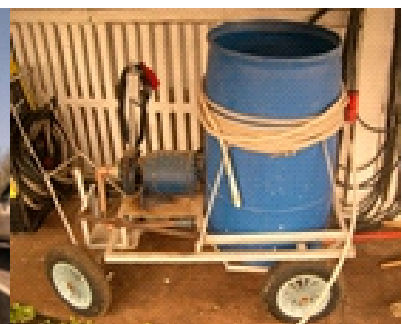
Tanque de lavado y desinfección.
