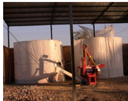
Moledora con toma de fuerza - Silos de campaña - Corrientes.
