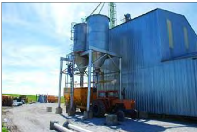
a) Planta de alimentos con capacidad de producción de 5000 kg por hora y una molienda para lograr altos índices de conversión. b) Área de partos. Los lechones recién nacidos pasan entre 18 y 21 días hasta el destete.
