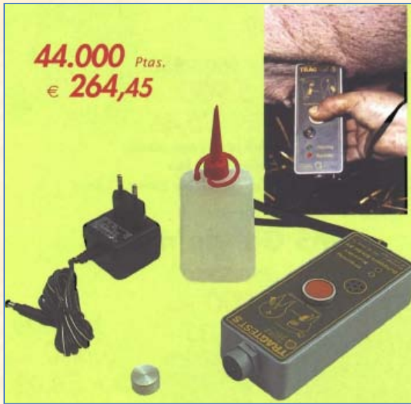
Ecografía tipo A (aparato sin pantalla): cabezal transductor unido a una analizador ultrasónico
