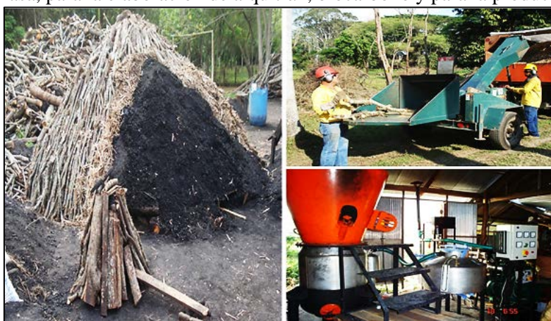
Figura 13. Pila para la elaboración de carbón vegetal, picado de la madera rameal para convertirla en aserrín y gasificador de la biomasa, para la elaboración de alquitrán, biocarbón y para la producción de gas de síntesis.
