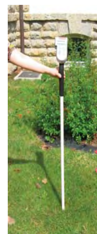
Herbómetro por capacitancia.
