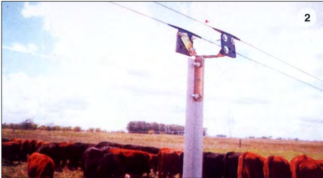
Foto 2.- De cada lado de la franja dos alambres soportados por un perfil de aluminio sirven de guía y alimentación a los carritos de avance; Foto 3.- El carrito de avance (visto de abajo) lleva cuatro rueditas de guía y centrales de tracción que reciben el movimiento de sendos motorcitos eléctricos.
