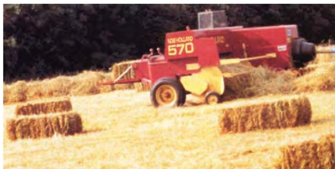
Se realiza con la máquina denominada empacadora. Las que podríamos denominar de tipo convencional recogen el heno depositado en la hilera, lo comprimen dándole una forma prismática, sujetan el prisma atándolo con sisal o alambre y lo devuelven al terreno para que continúe el secado.
