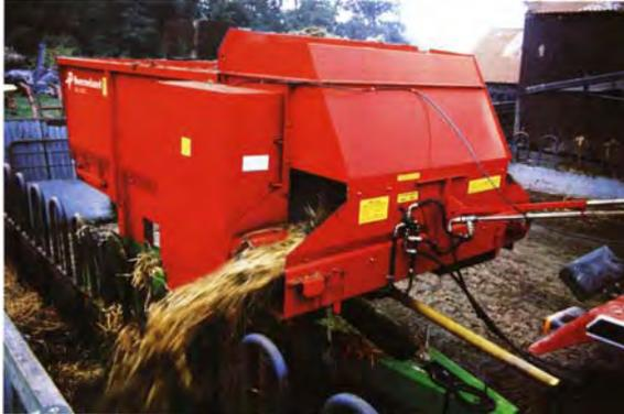
Remolque mezclador para preparación y distribución de raciones
