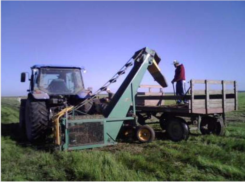
Figura 5. Plantadora semi-automática de panes de tierra. (Foto cortesía Roberto Shaffer)
