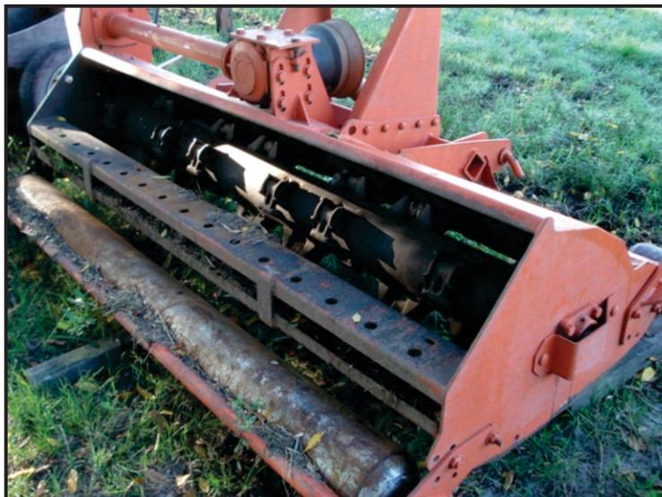
**Foto 3.** Máquina desmalezadora utilizada en la experiencia. Realiza un trabajo de corte y desmenuzado.
